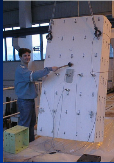
Dynamický test na desce
